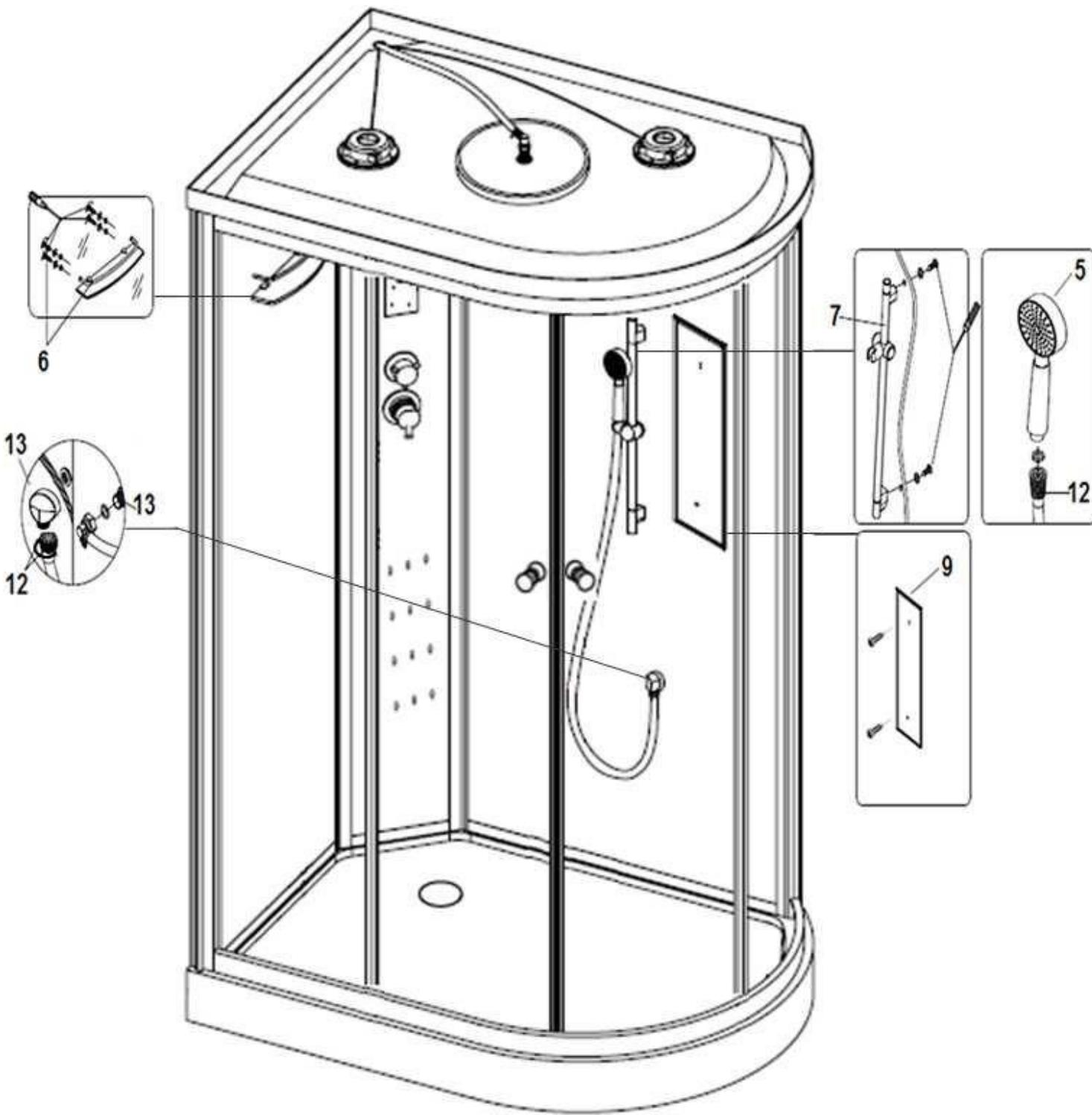
Этап сборки. Места нанесения герметика
